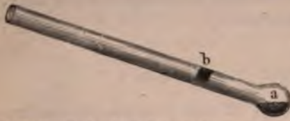
Fig. 137. — Recherche de l'arsenic dans un tube par calcination d'acide arsénieux avec le charbon.
